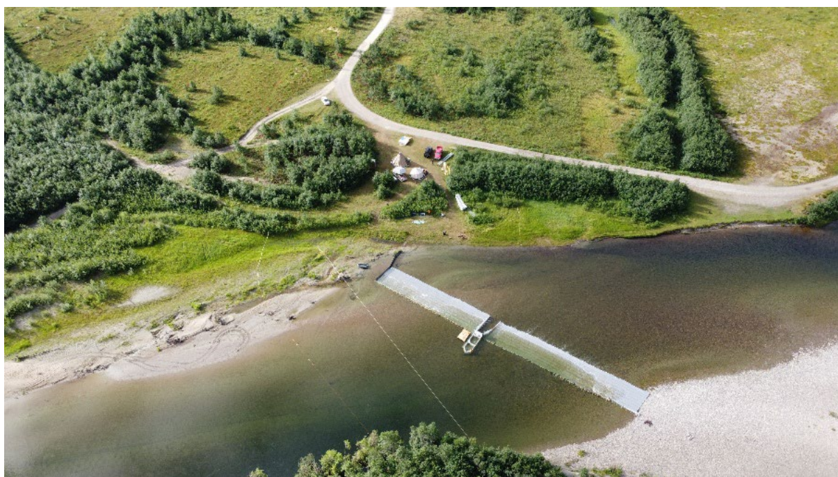
Figur 8.3. Dronefoto av komplett pukkellaksfella i Lakselva. Foto: Jan Henrik Hætta
