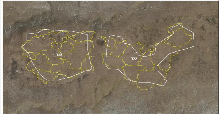
Figur 25. Bakkesannheter og segmentering. Bakkesannheter tegnet i hvit med hovedtype T22 i dette eksempelet. Segmenteringen i gult.
