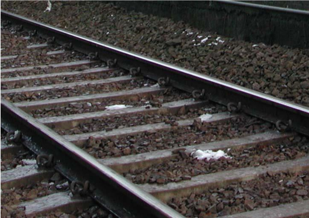
Figur 8: Skinnetilstand har stor betydning for støyen. Foto: Miljødirektoratet
