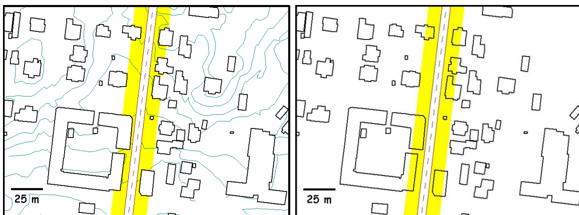
Figur 44. Rød og gul støysone - lite trafikk. Komplette nordisk beregningsmetode i figur til venstre, sjablongmetode i figur til høyre.
