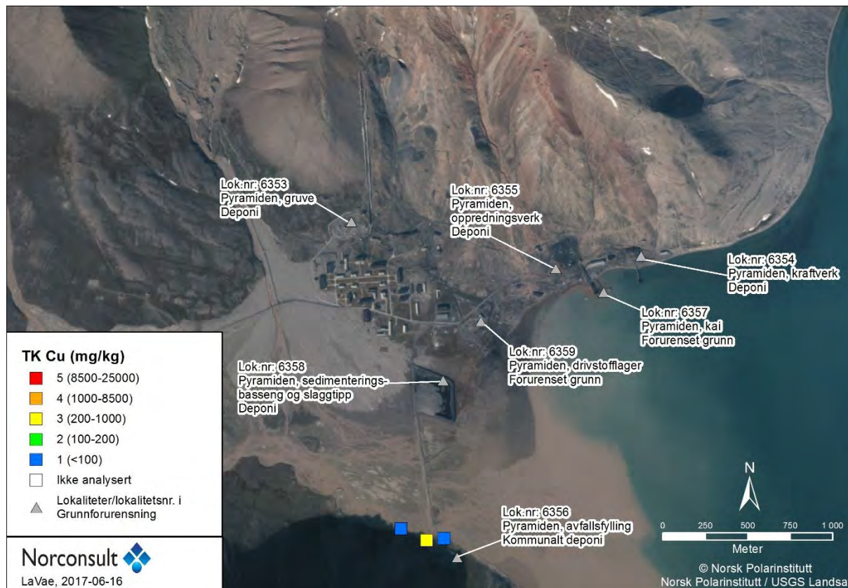
Figur 22: Pyramiden; sammenstilling av analyseresultater for kobber (Cu) i jord, fargekodet etter tilstandsklasse iht. TA2553/2009 (SFT, 2009). Sammenstillingen omfatter data fra grunnlaget omtalt i kap. 2.
