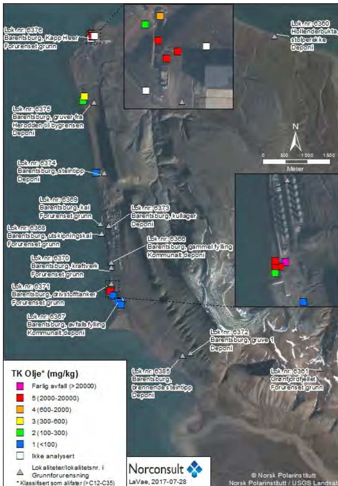
Figur 9: Barentsburg; sammenstilling av analyseresultater for mineralolje i jord, fargekodet etter tilstandsklasse for alifater (>C12-C35) iht. TA2553/2009 (SFT, 2009). Sammenstillingen omfatter data fra grunnlaget omtalt i kap. 2.
