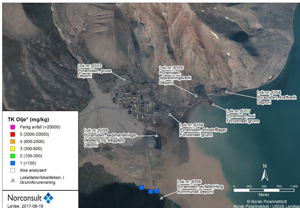
Figur 19: Pyramiden; sammenstilling av analyseresultater for mineralolje i jord, fargekodet etter tilstandsklasse for alifater (>C12-C35) iht. TA2553/2009 (SFT, 2009). Sammenstillingen omfatter data fra grunnlaget omtalt i kap. 2.
