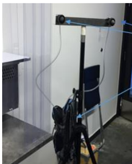
Bilde 1: Prøvetakingsutstyret montert klar til prøveinnsamling
