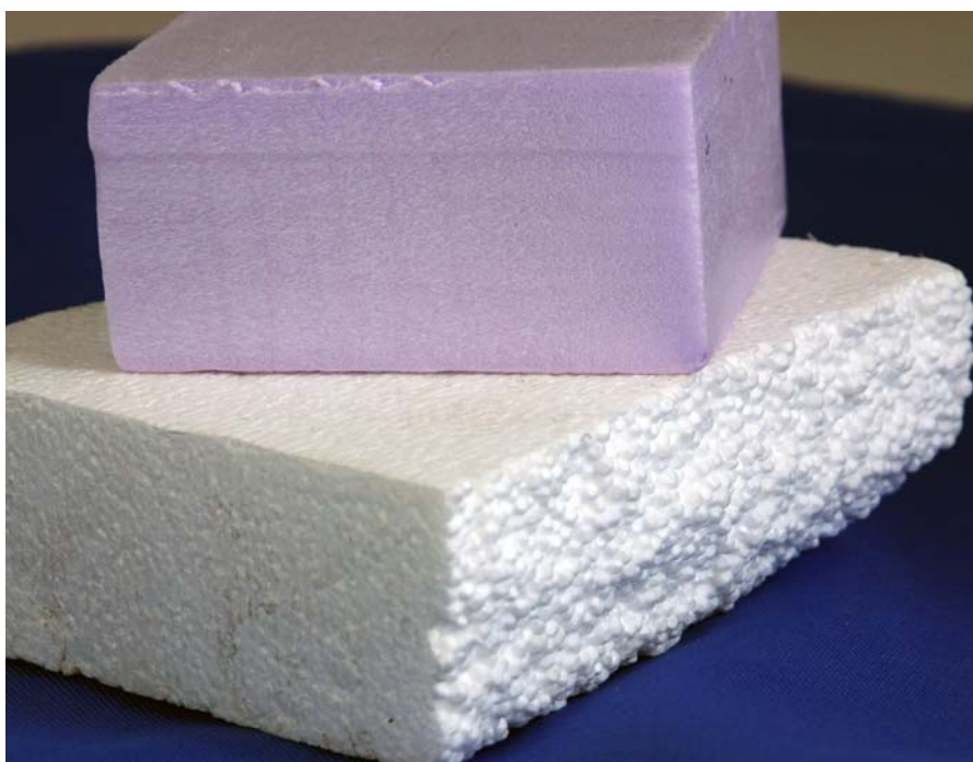
XPS-isolasjon (øverst) og EPS-isolasjonsskum kan inneholde bromerte flammehemmere (Foto: SFT)
