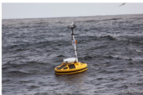
Autonom bøye stasjonert på værstasjon M i Norskehavet. Fra bøya måles kontinuerlig CO_2 -innholdet i havoverflata og atmosfæren. I tillegg måles salt, temperatur, oksygen og pH i havet, samt vind og bølger (Foto: Helge Bryhni, UiB).
