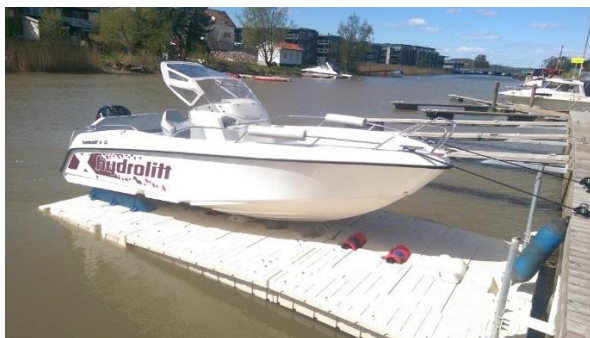
Figur 7: Flytedokk, foto fra Evan Rebech, Nordic Boatlift..
