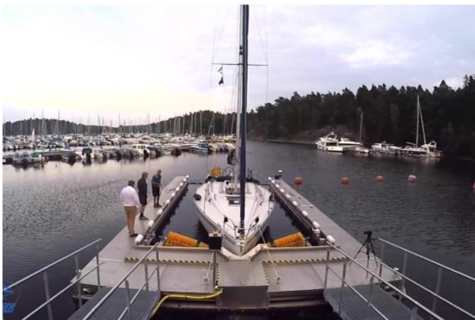
Figur 2: Stasjonært skrogvaskeanlegg fra Rent Under AB
