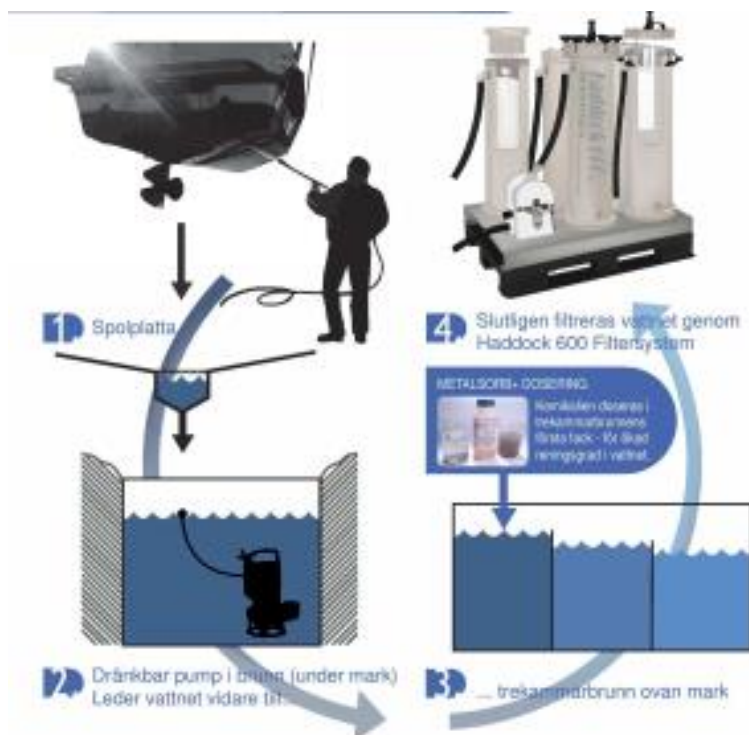
Figur 18: Prinsippsskisse for IFAB skrogvaskeløsning med renseanlegg
