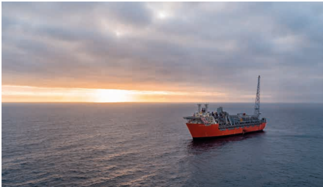
Skarv FPSO. Produksjonsskip med lagrings- og lossekapasitet (FPSO – Floating production, storage and offloading). Foto: Øyvind Gravås / Woldcam for Aker BP
