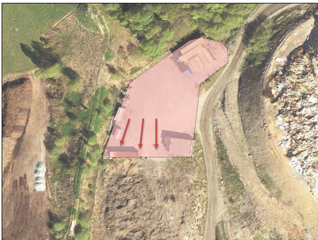
Figur 10. Oversiktsbilde over aktivt brannøvingfelt på Lindum Drammen (rød skravur), samt piler som viser trolige spredningsveier for brannskum.
