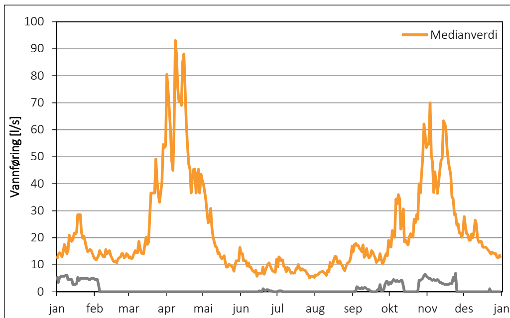
Figur 40 Vannføring Kjorbekkdalen (l/s), den gule medianverdien viser at bekken går tørr noen dager i året. Multiconsult in 2017.
