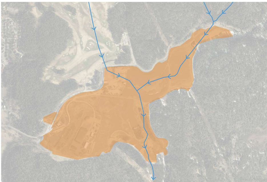
Figur 15 Deponiområdet på Grønmo med det eksisterende rør- og bekkenettet markert i blått. Her ser man tydelig hvor bekken løp før det ble fylt på med masser. Illustrasjon Worksonland/ Elisabeth Sjødahl
