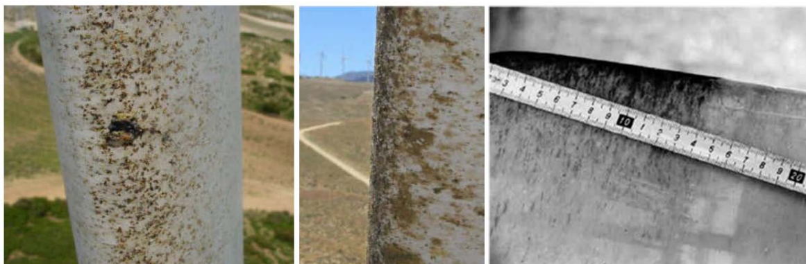
Figur 1. Eksempler på rester av insekter på rotorblader til vindkraftverk. Venstre: rester av en svermende bille ( Omophlus lepturoides ) (BladeCleaning 2018). Senter: ikke identifiserte insektrester på rotorblad (Wilcox et al. 2017). Høyre: Nedsølt bladfront på rotorblad nær bladets spiss (Hinsch & Westermann 1996). Bildekomposisjonen er hentet fra Trieb (2018).
