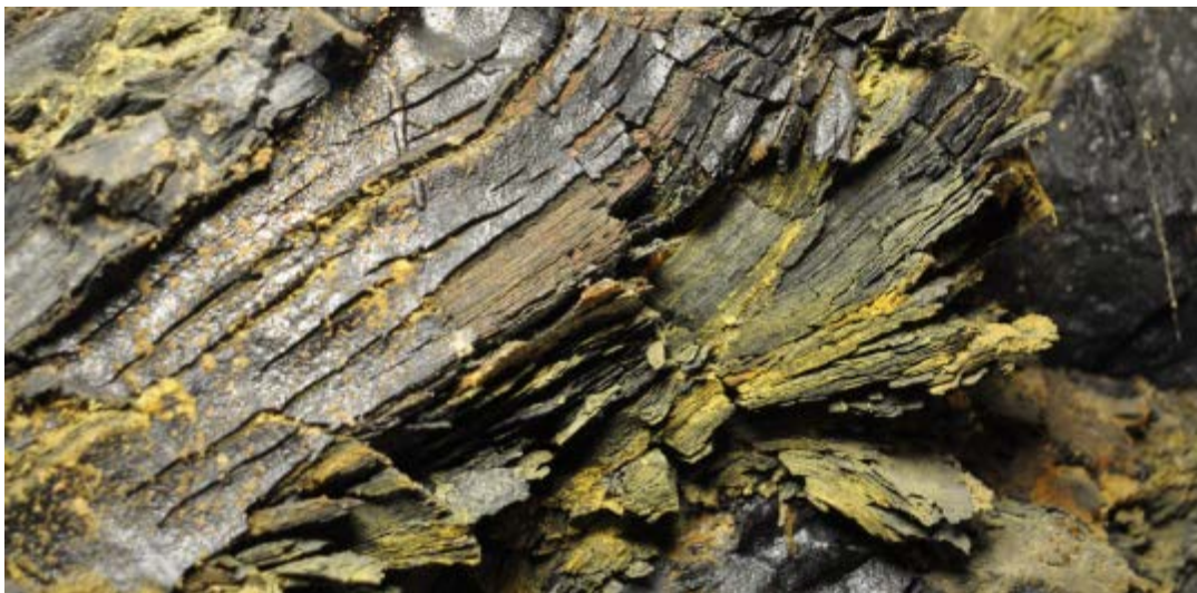
Figur 1 Alunskifer som forvitrer ved tilgang på fuktig luft vil svulle til et volum som kan være 2-3 ganger opprinnelig volum (høyden på bildeutsnittet er ca. 5 centimeter). Gule utfellinger er Fe_2(SO_4)_2 mineraler (jarositt eller koptiatitt).
