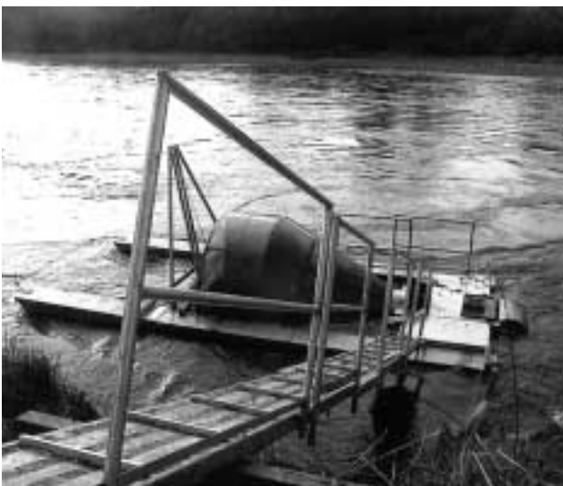
Figur 6.11. Smoltskrue plassert på strømsiden av elva.
