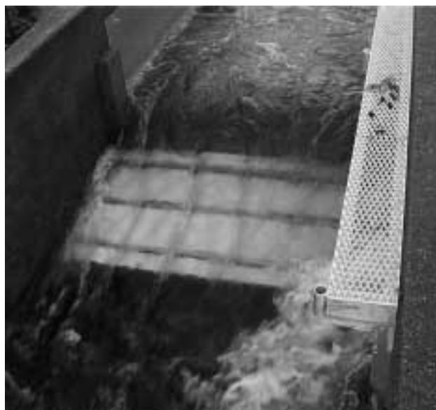
Figur 8.2. De tre elektrodene som registrerer endringer i vannets ledningsevne ble montert i fisketrappa. Sterk vannstrøm over elektrodene sikrer rask fiskevandring.
