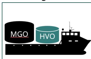
Figur 7: Salg av biodrivstoff til olje- og gassinstallasjon basert på separat tankinfrastruktur. Forsyningsfartøyet benytter dedikerte tanker til biodrivstoff. I dette eksempelet kjøper olje- og gassinstallasjonen alt biodrivstoffet på tanken til forsyningsfartøyet.
