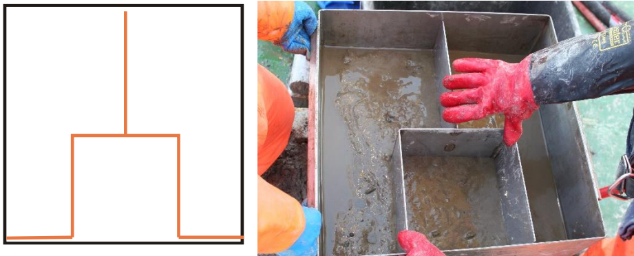
Figur 2-2: Oppdeling av biologi- ( 2 \times 0,1 \text{ m}^2 ) og kjemiprøver ( 1 \times 0,05 \text{ m}^2 ) fra bokscorer.
