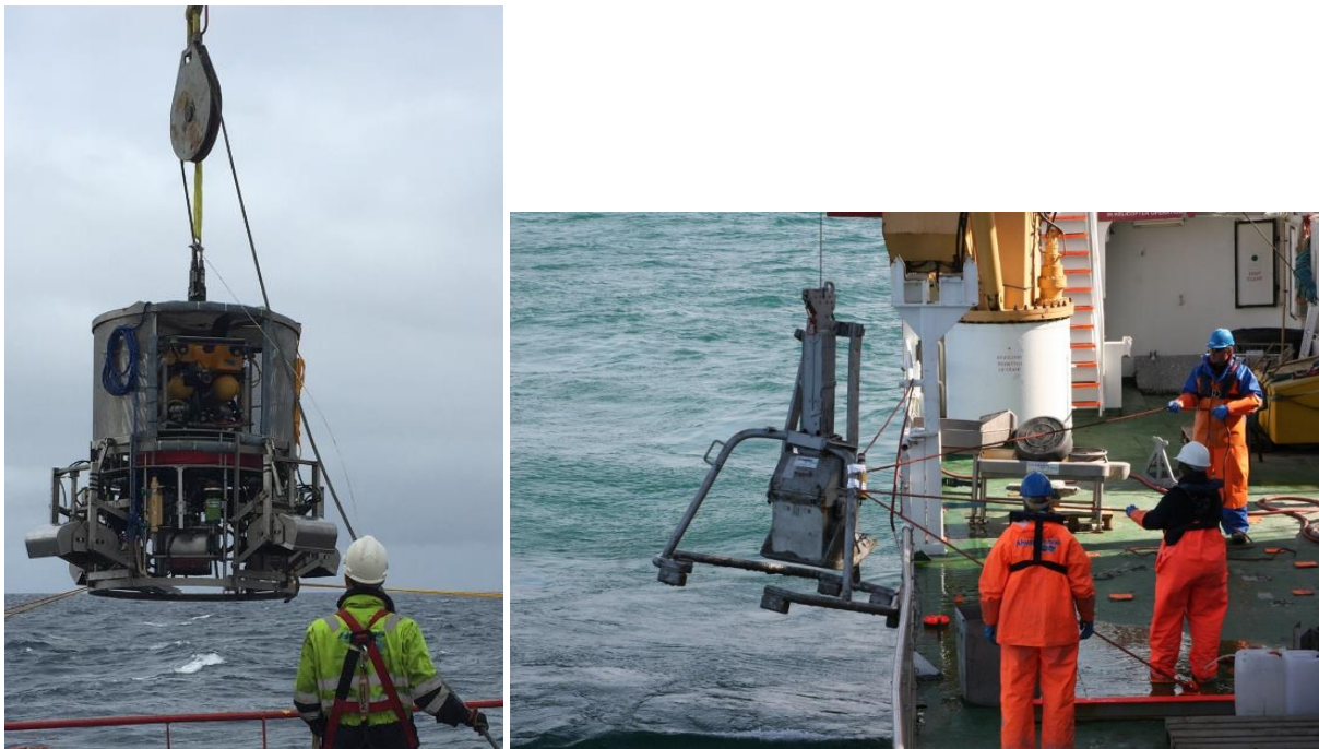
Figur 2-1: VAMS (Video Assisted Multi Sampler) og bokscorer (foto: Akvaplan-niva).
