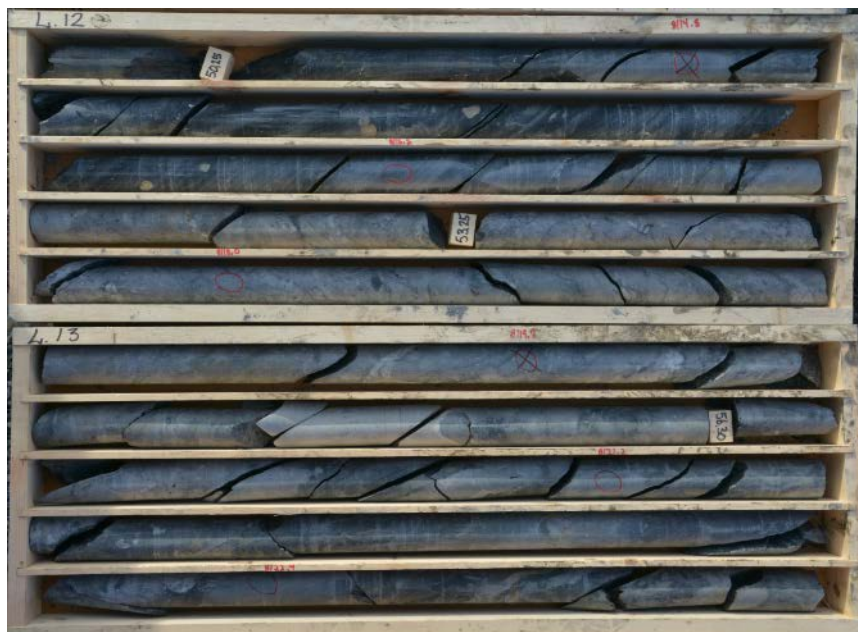
Figur 6 Prøver fra kjerneboring. De øverste fire kjernene er galgebergskifer (3b6) og de nederste seks kjernene er fra Hukformasjonen (3c). Se tabell 2 for nærmere forklaring av etasjene. Foto: Erik Endre
