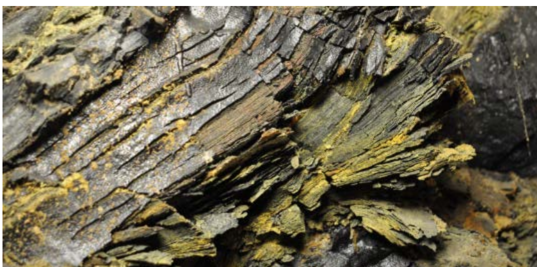
Figur 1 Fotoet viser alunskifer i tynne flak som forvitrer ved tilgang på fuktig luft og vil swelle til et volum som kan være 2-3 ganger opprinnelig volum. Høyden på bildeutsnittet er ca. 5 centimeter. Gule utfellingene er jernsulfat ( \text{Fe}_2(\text{SO}_4)_3 ). Foto: Erik Endre
