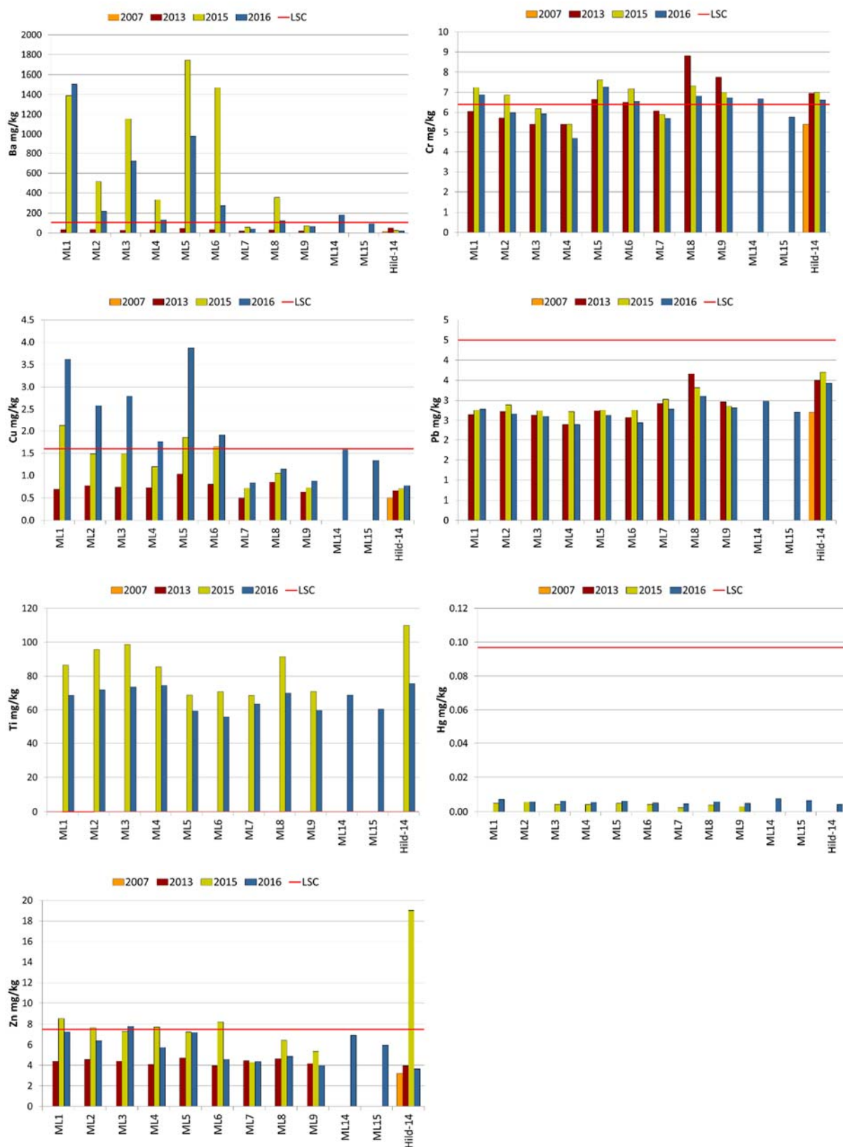
Figur 4.3-4 Martin Linge 2016, metallinnhold (mg/kg) i toppsedimentet (0-1 cm) fra tre parallelle prøver. Cd er utelatt da alle resultater er under deteksjonsgrensen.
