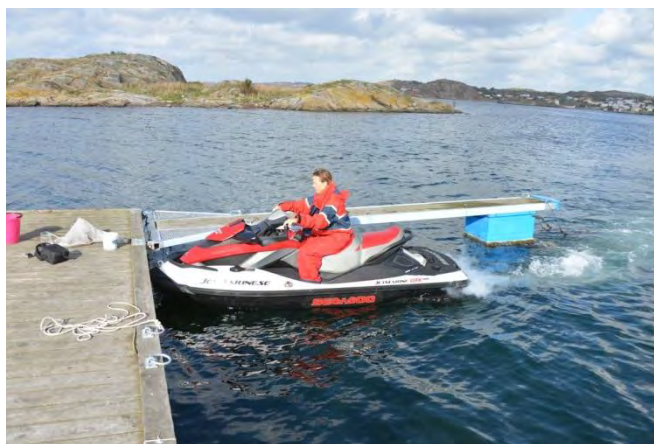
Figur 4 Testuppställning med körande vattenskoter. Prover togs med planktonhäv i utvattnet efter vattenskotern vid olika varvtal.
