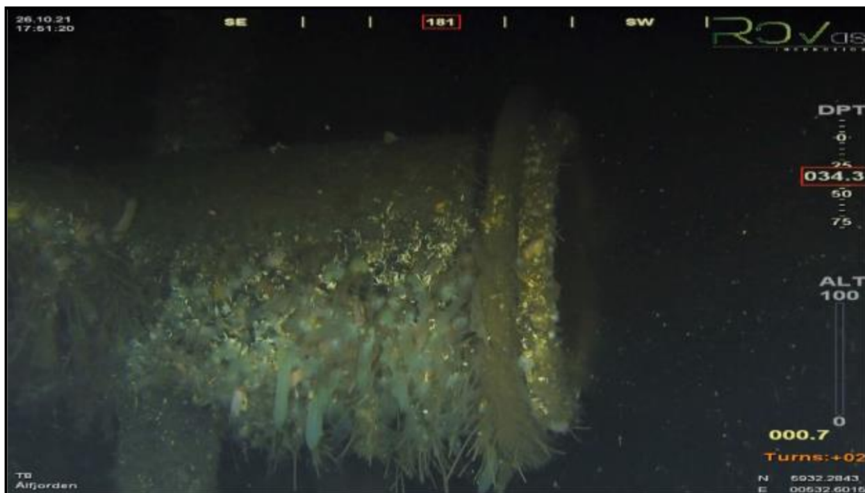
Figur 1 - Avløpsrøret funnet under ROV-undersøkelse fra 2022 av Rådgivende biologer i området hvor det gamle aktive avløpsrøret til virksomheten skal være.
