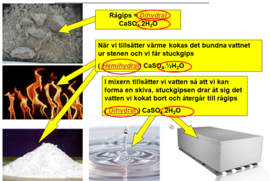
Figur 1 Illustrasjon over hvordan rågips blir til ferdige gipsplater (Gustavsson, 2018)
