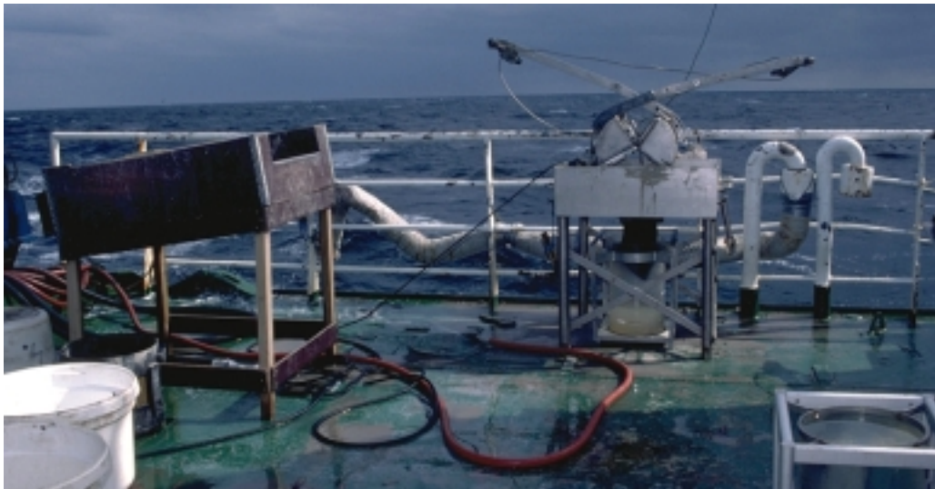
Figur 3.2. Grabb, mottaksbord, målesylinder og vaskebord benyttet på Castor (bildet er fra feltarbeid gjennomført på Haltenbanken i 2000).
