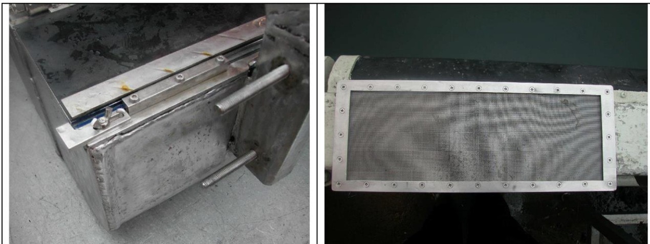
Venstre: låsmekanisme for lokk og fastsveisede bolter for lodd. Høyre: lokk med 0,5 mm duk
