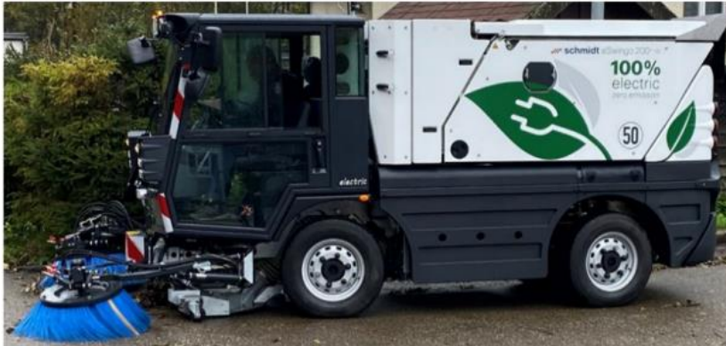
Eksempler på mindre EL feie-/oppsugsmaskiner med oppsamlerfunksjon
