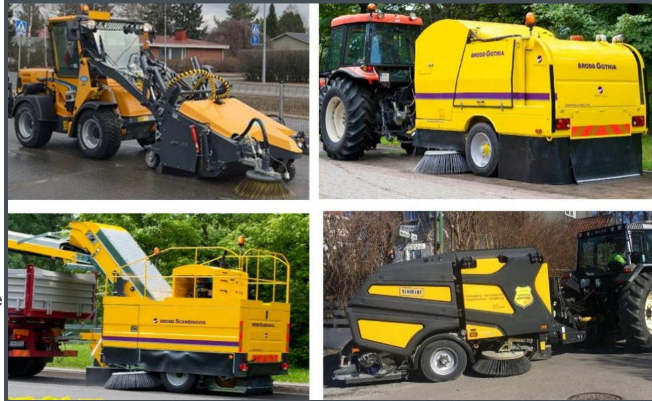
Feiemaskin med kost og mekanisk oppsamling
