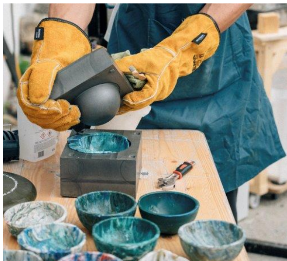
ET NYTT LIV FOR AVFALL: HAVPLAST BLIR KVERNET I 3D-PRINTEDE STØPEFORMER TIL NYE PRODUKTER. BILDE: ELIN FRÖDERBERG
